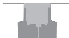
Installazione a filo pavimento
