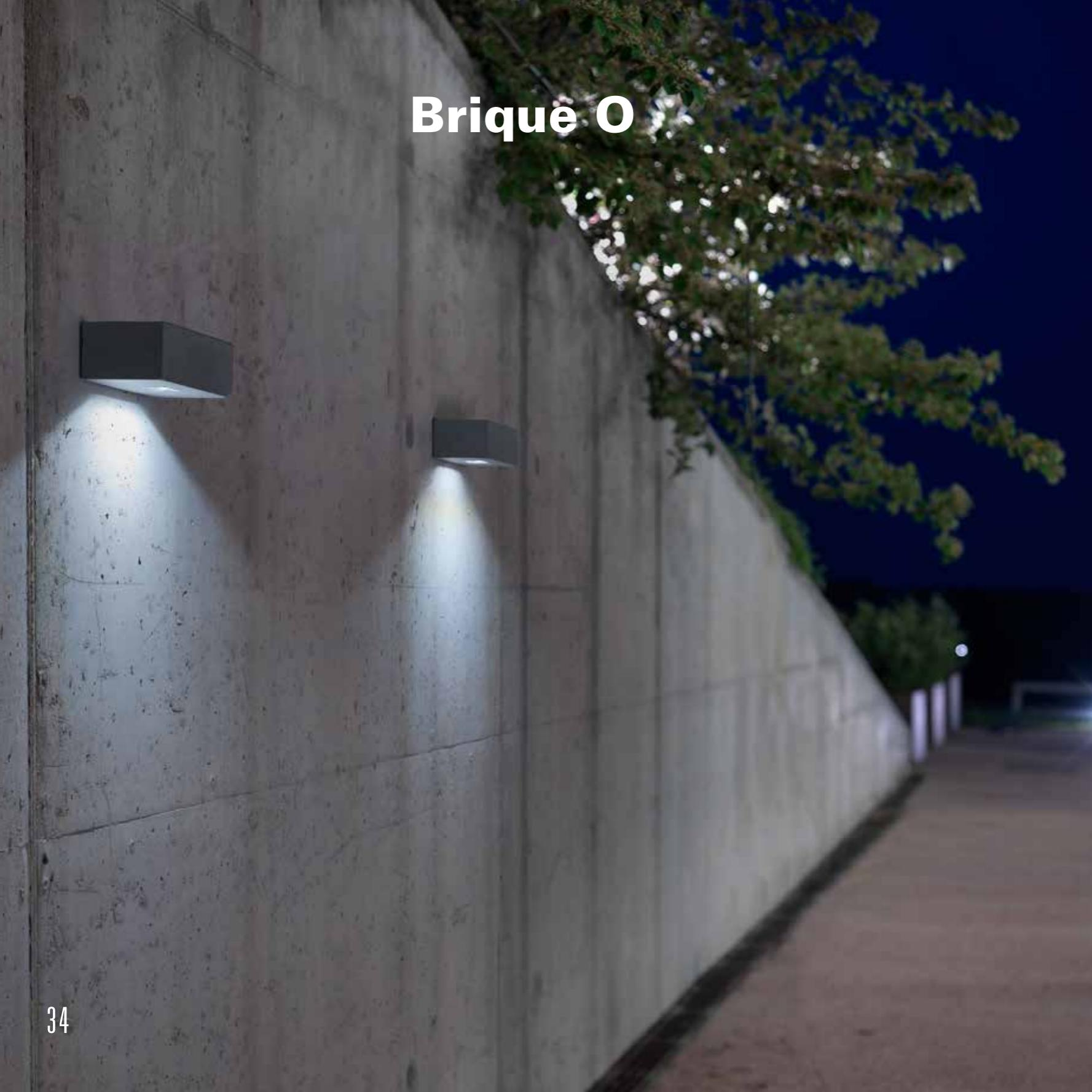
Apparecchio da parete per illuminazione di interni ed esterni con sorgenti LED, disponibile in versione mono-emissione e bi-emissione. Corpo in VFRC (vinilic fiber reinforced concrete) con finitura "cemento lisciato" realizzata a mano. Gruppo ottico in alluminio completo di sorgente LED da 6/6+6W, alimentazione elettronica integrata 50/60 Hz 230/240V, piastra di montaggio in acciaio per il fissaggio a parete. Grado di protezione IP65.
