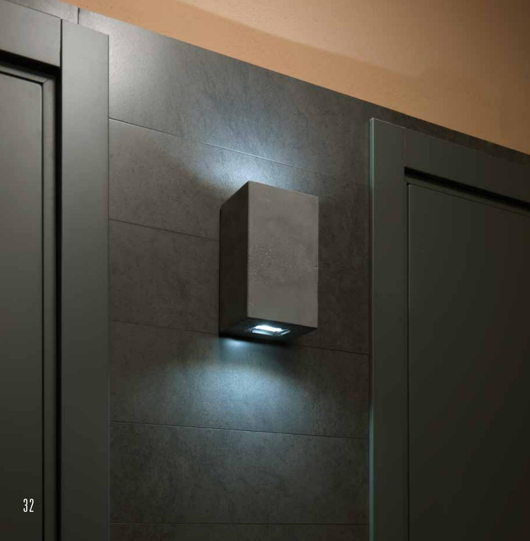
Apparecchio da parete per illuminazione di interni ed esterni con sorgenti LED, disponibile in versione mono-emissione e bi-emissione. Corpo in VFRC (vinilic fiber reinforced concrete) con finitura "cemento lisciato" realizzata a mano. Gruppo ottico in alluminio completo di sorgente LED da 6/6+6W, alimentazione elettronica integrata 50/60 Hz 120/240V, piastra di montaggio in acciaio per il fissaggio a parete. Grado di protezione IP65.
